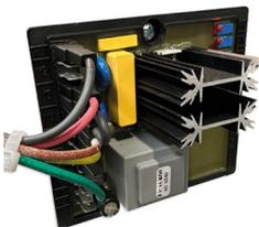
Genauigkeit Automatischer Spannungsregler (AVR) +-1%.
